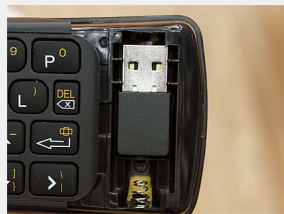
USBレシーバーはキーボード側に収納可能(ただし収納時は電池を抜く必要あり)
